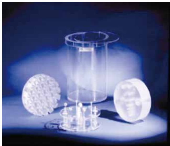
Figure 1. 本次實驗假體 Fluke 公司製造的 Model 76-823。
