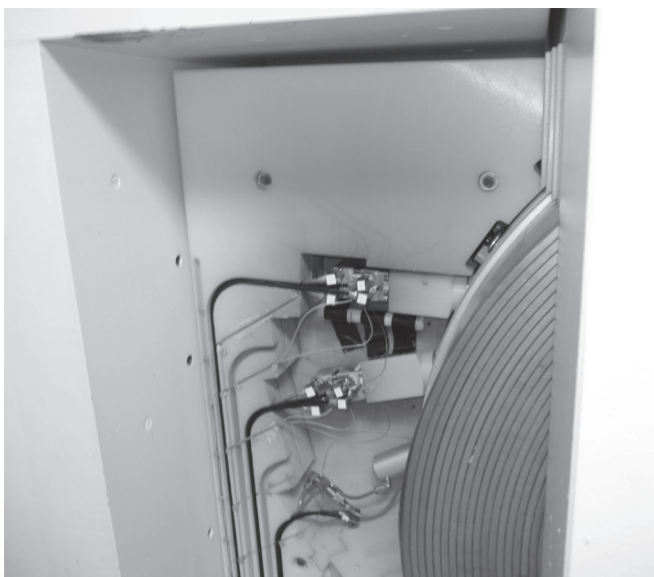
圖 3. 迴旋加速器的 1 號靶極及圓柱型 PE 板位置，評估加速器經過 ^{18}\text{O} (p,n) ^{18}\text{F} 後產生的中子能譜。
