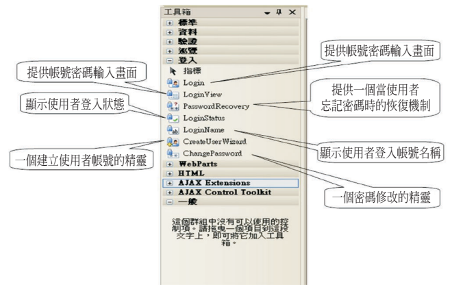
Fig. 3 利用工具箱內的「登入控制項」，可以完成登入頁面、註冊新帳戶頁面，找回密碼頁面、更改密碼頁面等網站安全管理系統。
